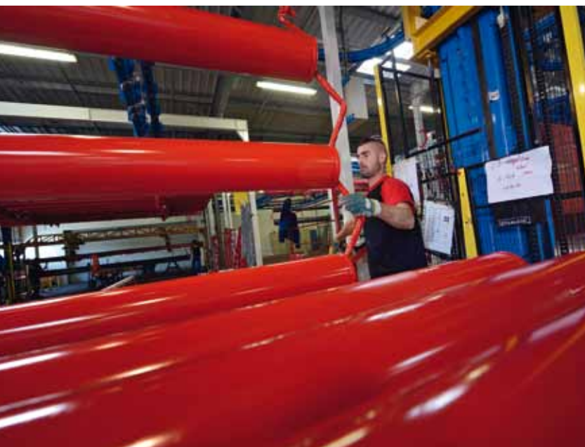
Le palonnier fait descendre automatiquement les tuyaux après qu'ils ont été peints.
